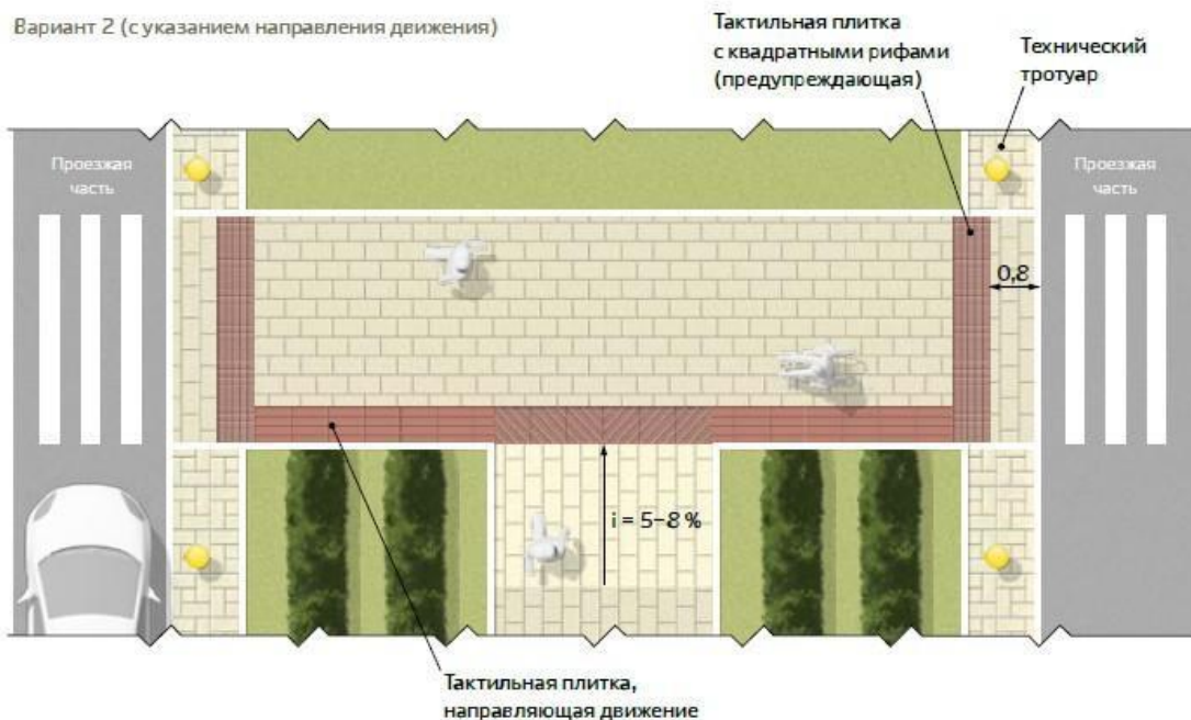
Рисунок 13– Размещение тактильных плит на пешеходных тротуарах, расположенных на уровне проезжей части (вариант 1,2)
