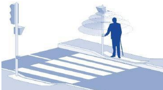
Рисунок 14. – Примеры размещения направленности действия технических средств звуковой сигнализации на регулируемых пешеходных переходах
