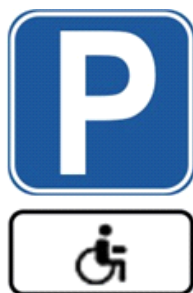
Рисунок 15. – Примеры обозначения машиноместа для стоянки (парковки) транспортного средства инвалида с использованием дорожных знаков
